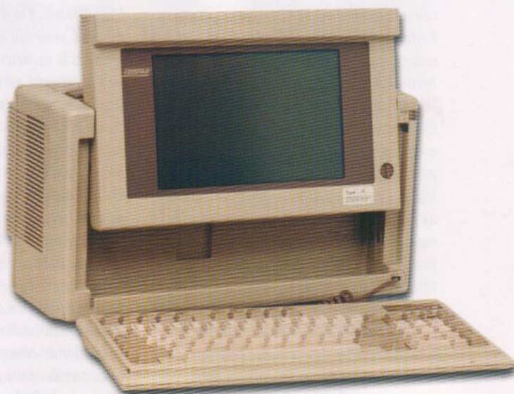
■ Ordinateur Compaq III, 1990. Avant de parvenir à la forme que l'on connaît aujourd'hui, les constructeurs ont tenté des formes parfois originales, comme ce modèle dont l'écran se rétractait à l'intérieur du boîtier.
